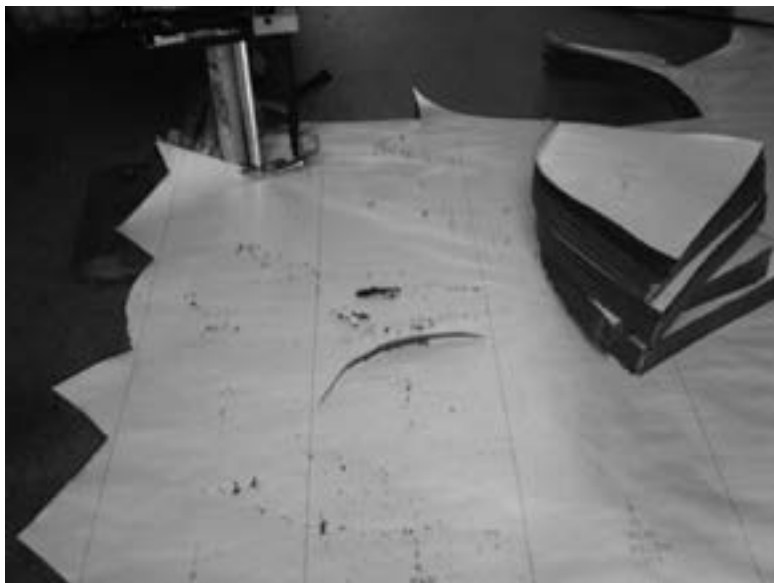
Cortador extrayendo las piezas del trazo del modelo con la máquina cortadora. Propiedad del autor.
